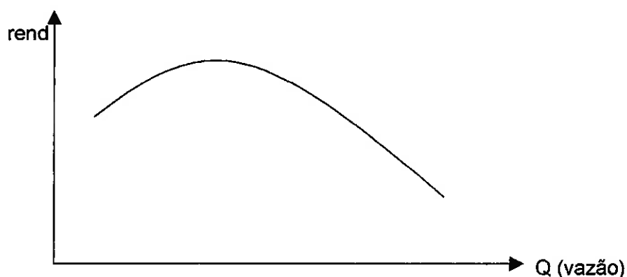
Fig.8 Ilustração da dependência entre rendimento e vazão num compressor
